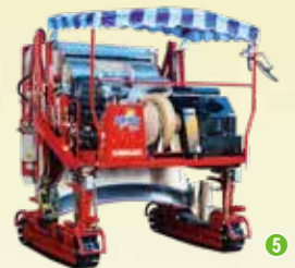
①製茶解説書における茶摘みの挿絵(「製茶図解」、明治4年、彦根藩) ②茶摘みの写真(「A Pictorial Shizuokaken Tea Industry」、昭和9年、静岡県茶業組合聯合会議所) ③茶摘みばさみ ④可機型摘採機(落合刃物工業株式会社所蔵) ⑤乗用型摘採機(カワサキ機工株式会社所蔵) ※写真はイメージです。※古書及び絵画資料は、資料の劣化を防ぐため写真パネルでの展示を予定しています。※大型機械は、スペースの関係上、写真での展示を予定しています。 ※実際の展示では、機械の型式が変更になる可能性があります。
